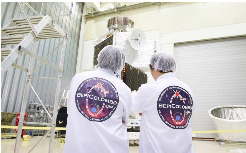
**B**epiColombo vista al centro test dell'ESA il 6 luglio 2017. La navicella per Mercurio dell'ESA ha passato il test finale in configurazione di lancio. Per prepararla alle severe condizioni delle vicinanze del Sole, la navicella è stata sottoposta ad ampie prove, sia come unità separate, sia nella configurazione di lancio e crociera alta 6 metri. [ESA-Philippe Sebirot]
