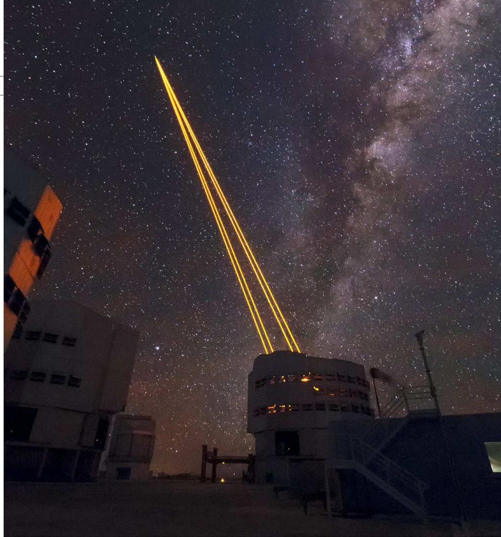
**I**l sistema 4LGSF (four Laser Guide Stars Facility) punta al cielo durante le prime osservazioni con lo strumento MUSE combinato con AOF. L'ottica adattiva assiste i telescopi da terra compensando l'effetto di sfocatura della luce delle stelle dovuto all'atmosfera terrestre. [Roland Bacon]
